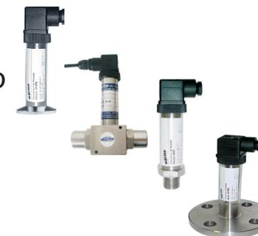
Os transmissores de pressão *550 Séries*, são fabricados para realizar medições de pressão: relativa, absoluta e diferencial. São confeccionados em aço Inox 316 e dispõem de diversas conexões ao processo, tais como: rosca, flange e tri-clamp, para atender as diversas necessidades da indústria. Possui um circuito eletrônico compacto e de alta confiabilidade, com componentes em SMD, com ótimo desempenho ao condicionamento de sinal e estabilidade na saída analógica 4...20mA.
