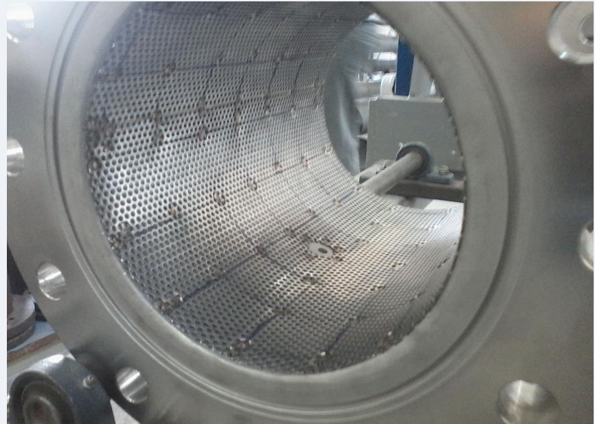
TELA PERFURADA PARA ANCORAGEM DO REVESTIMENTO
