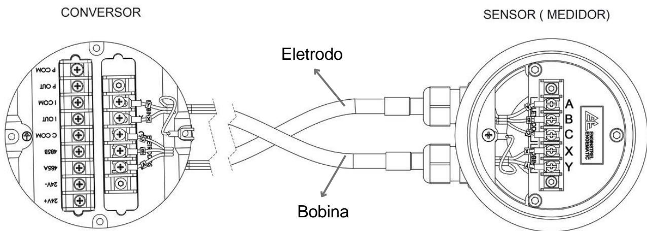
Figura 30 - esquema de ligação do transmissor 584TM ao conversor 584TM
