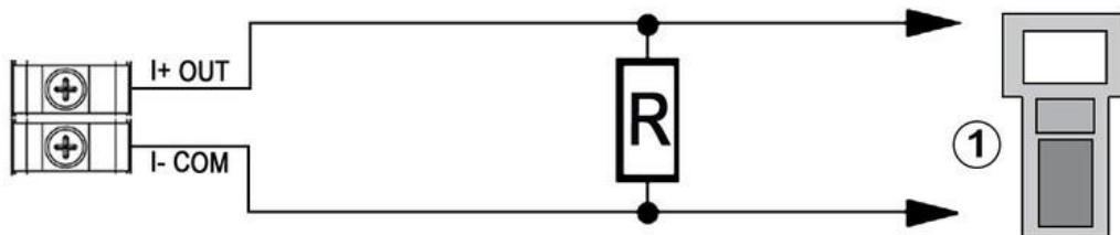
Figura 12 - Conexão HART® ativa (1)
