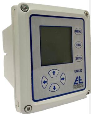
O Transmissor UNI 20 é altamente versátil, e os sensores digitais e analógicos existentes da Empresa pode ser conectado livremente, os parâmetros mensuráveis incluem pH, DO, ORP, Condutividade, Turbidez, Sólidos, Clorofila, Algas azuis esverdeadas, Cloro residual, UVCOD, Nitrogênio amoniacal iônico, Nitrogênio Nitrato, Transparência e outros parâmetros.
