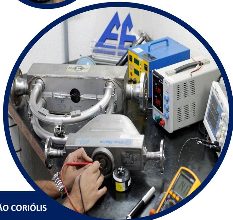
**CALIBRAÇÃO E REFORMA ESTRUTURAL EM MEDIDOR DE VAZÃO CORIÓLIS**
