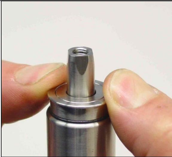
Figura 7-6. Instalación de la boquilla del eje de momento y de la arandela de sello.
