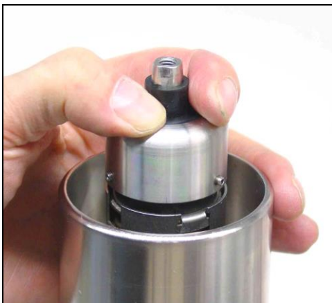
Figura 7-13. Instale la cubierta de la malla.
