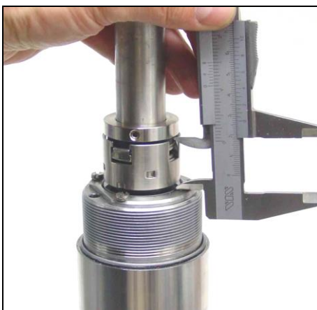
Figura 7-11. Ajuste de compresión del asiento trasero.
