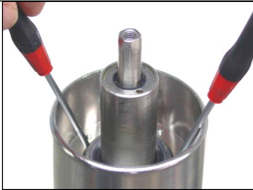
Figura 7-8c. Retire el asiento estacionario con dos desatornilladores.
