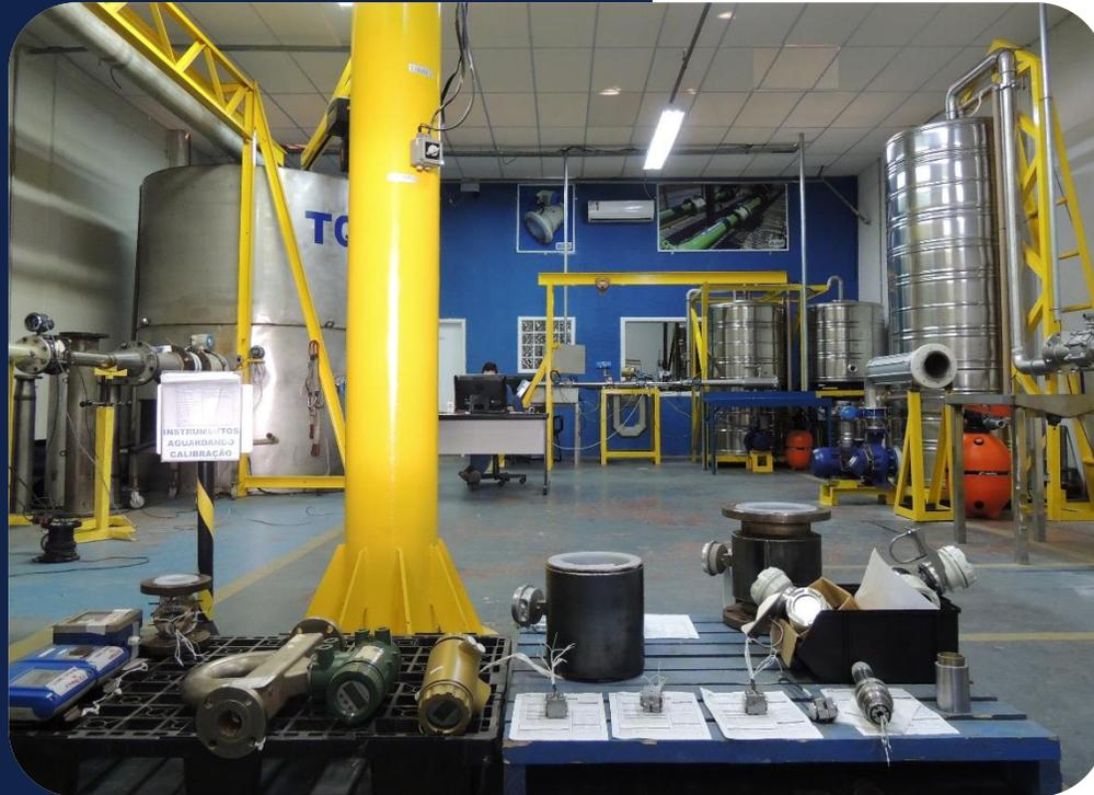
A **ENGINSTREL ENGEMATIC** possui um laboratório de vazão. Calibramos em nosso Stand de Calibração medidores de vazão entre 2,5mm (1/8”) a 600mm (24”).
